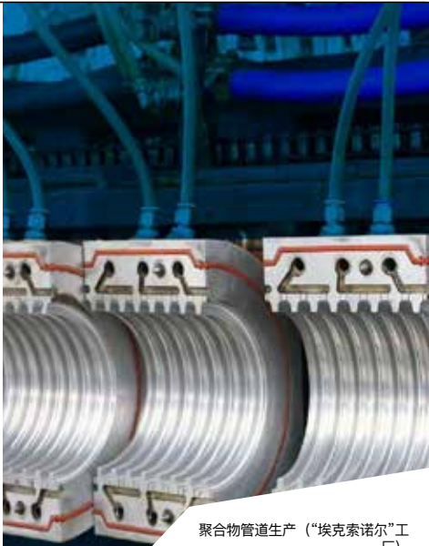
聚合物管道生产 (“埃克森诺尔”工厂)
